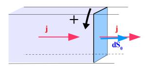
Le schéma symbolise un tube de champ élémentaire (la représentation est obligatoirement celle d'un tube de champ fini), parcouru par un courant  $\vec{j} = j\vec{u}$  ( $\vec{u}$ : vecteur unitaire). On veut déterminer le flux qui traverse la surface élémentaire  $dS_0$  de la gauche vers la droite, la surface ici est particulière car elle coupe le tube de champ perpendiculairement.
