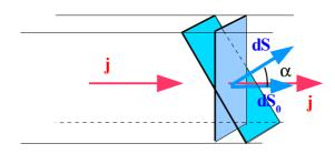
La surface dS ne coupe pas le tube perpendiculairement. Le flux qui traverse la surface élémentaire dS de la gauche vers la droite est le même que le flux qui traverse  $dS_0$  puisque l'on a coupé le même tube de champ.
